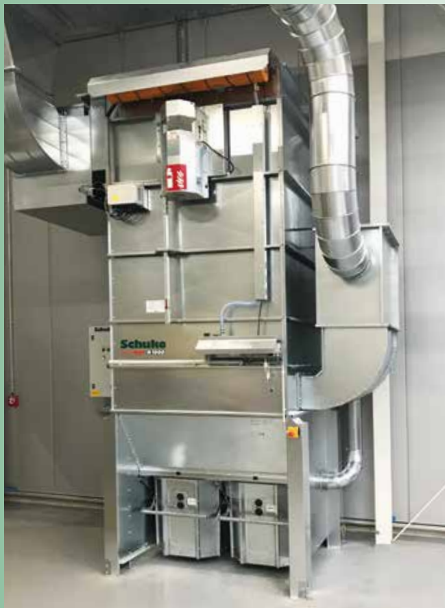
Vacomat N-1000 mit einer Filterfläche von 50 m 2
