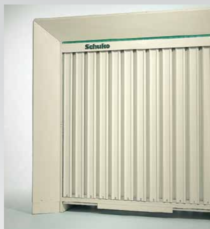
Suche ściany lakiernicze o powierzchni uderzeniowej z kartonu, włókniny filtrującej lub z metalu.
