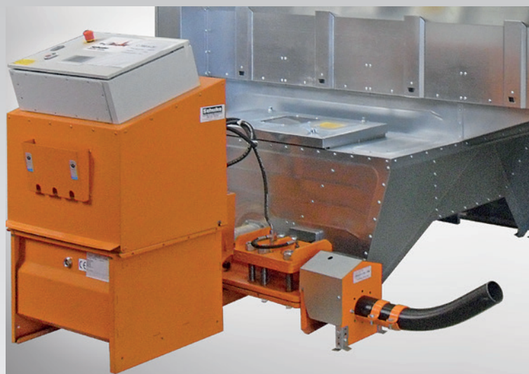
Pochłaniacz VACOMAT z pojemnikiem na wióry SPB 100/130 prasą do brykiety Compacto
